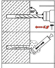
Bohrloch senkrecht zur Oberfläche des Verankerungsgrunds ohne Beschädigung der Bewehrung erstellen.
