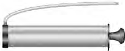
Ausblaspumpe (Volumen 750ml) Bohrerdurchmesser ( d_0 ): 10 mm bis 20 mm Bohrlochtiefe h_0 \leq 10 d_{nom} siehe Anhang B4
